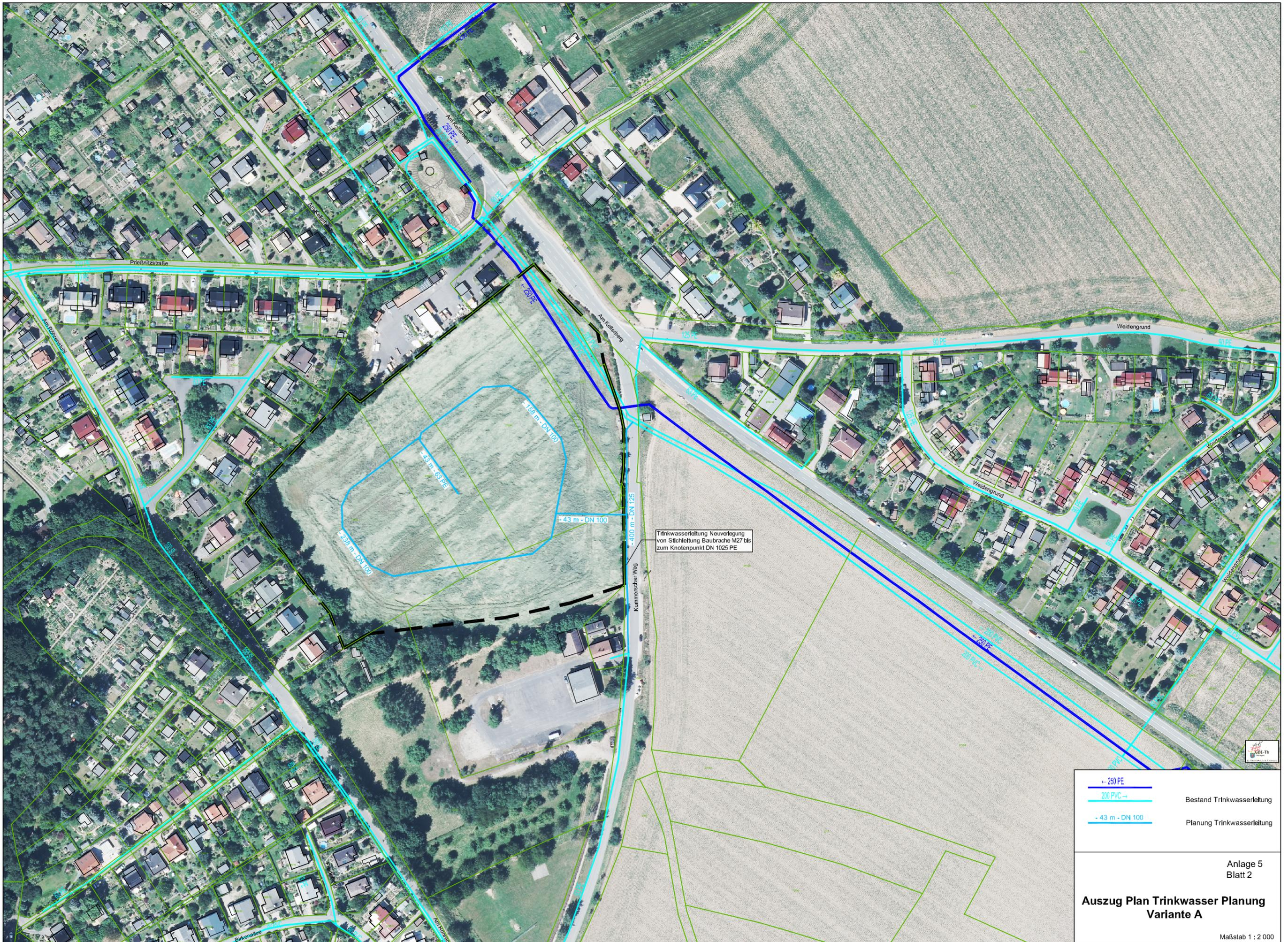
Trinkwasserleitung Neuverlegung von Stichleitung Baubrache M27 bis zum Knotenpunkt DN 1025 PE
