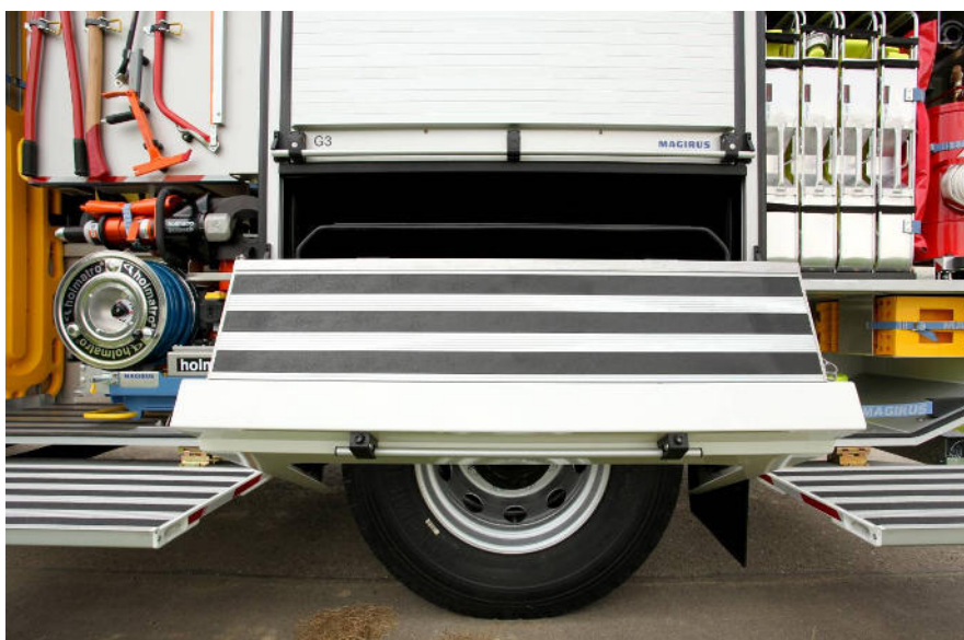
Öffnen und Schließen mit automatisch ab- und einklappender Trittsfläche
