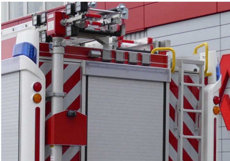
Heckblaulichter in der Dachgalerie integriert
