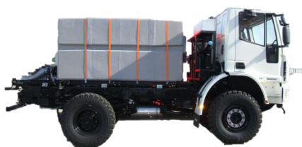
Tankbefestigung auf dem Grundrahmen
