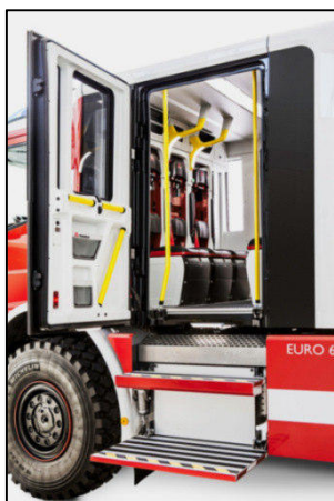
Klappbarer Einstieg zusammen mit den beiden Haltestangen im Einstiegsbereich
