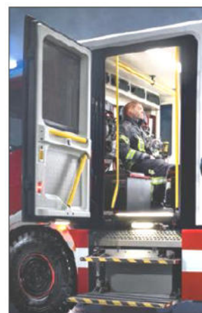
Klappbarer Einstieg zusammen mit den beiden Haltestangen im Einstiegsbereich
