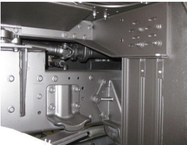
Unterbodenschutz für Unterboden, Aufbau, Grundrahmen und Fahrgestell und Fahrer- und Mannschaftsraum
