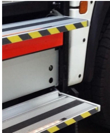
Klappbarer Einstieg geöffnet
