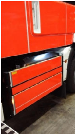
Klappbarer Einstieg geschlossen
