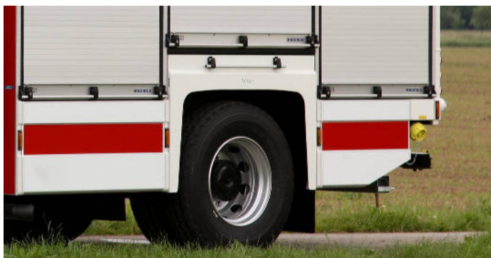
Klappbarer Kotflügel im AluFire-3-Design
