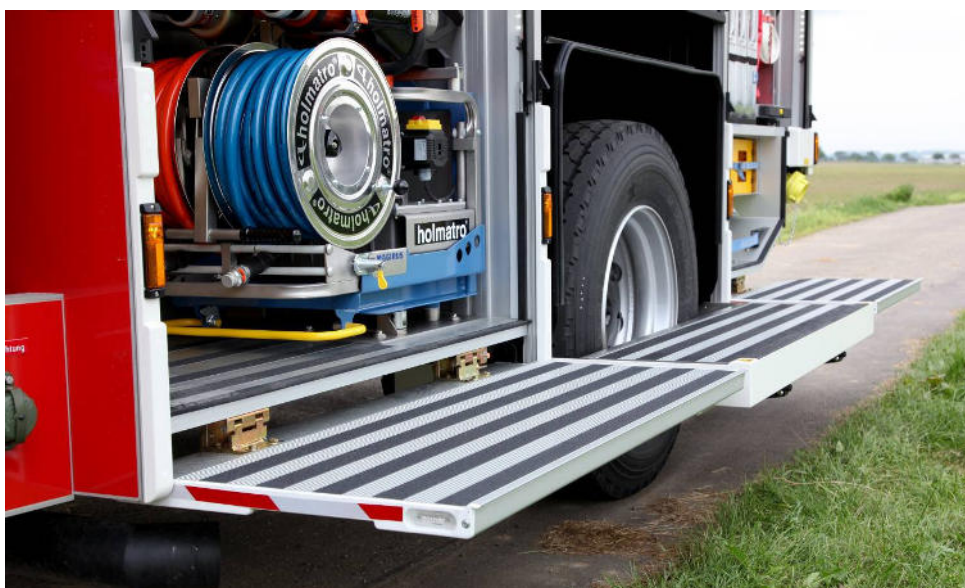
Absolut ebene und durchgängige Auftrittsfläche zur optimalen Entnahme von Ausrüstungsgegenständen über die komplette Aufbauhöhe; Warnmarkierung und LED-Warnleuchten (orange)
