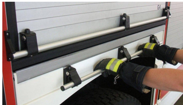
Drehstangenverschluss für ergonomische Bedienung
