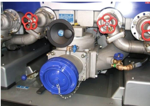
Tanksaugklappe mit Storz-Kupplung
