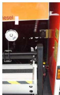
Optional mit durchgehender LED-Beleuchtung an der Trittfäche, Zugang zur Fremdstarteinrichtung, Befüllen des AdBlue-Behälters
