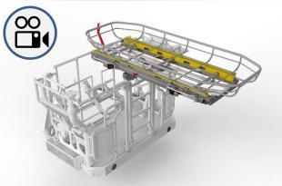
Für die Rettung von adipösen Personen ist für die Krankentragenlagerung ein Adapterrahmen für den Einsatz einer Schwerlasttrage erhältlich.
