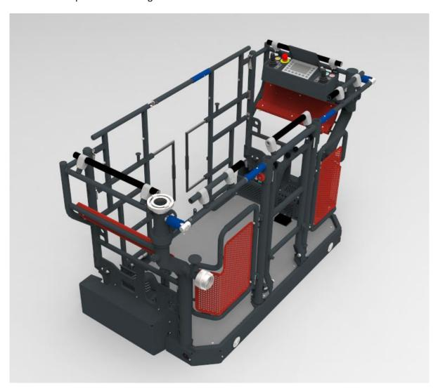
Der moderne 5-Mann-Korb mit einer Nutzlast von 500 kg und 300 kg SKL Last verfügt über eine bewerte 2-Zapfen-Aufnahme für eine Krankentrage, die nicht nur auf die Reling, sondern jetzt auch direkt auf dem Korbboden aufsteckbar ist. Durch die entnehmbare Multifunktionssäule ist es bei Drehleitern nun zum ersten Mal möglich einen Rollstuhl aufzunehmen.
